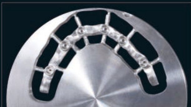
CAD/CAM M1 WET HEAVY 밀링 : 모델, 임시보철물, 티타늄바, 나사선 스크류 채널과 스크류를 체결한 지르코니아 보철
